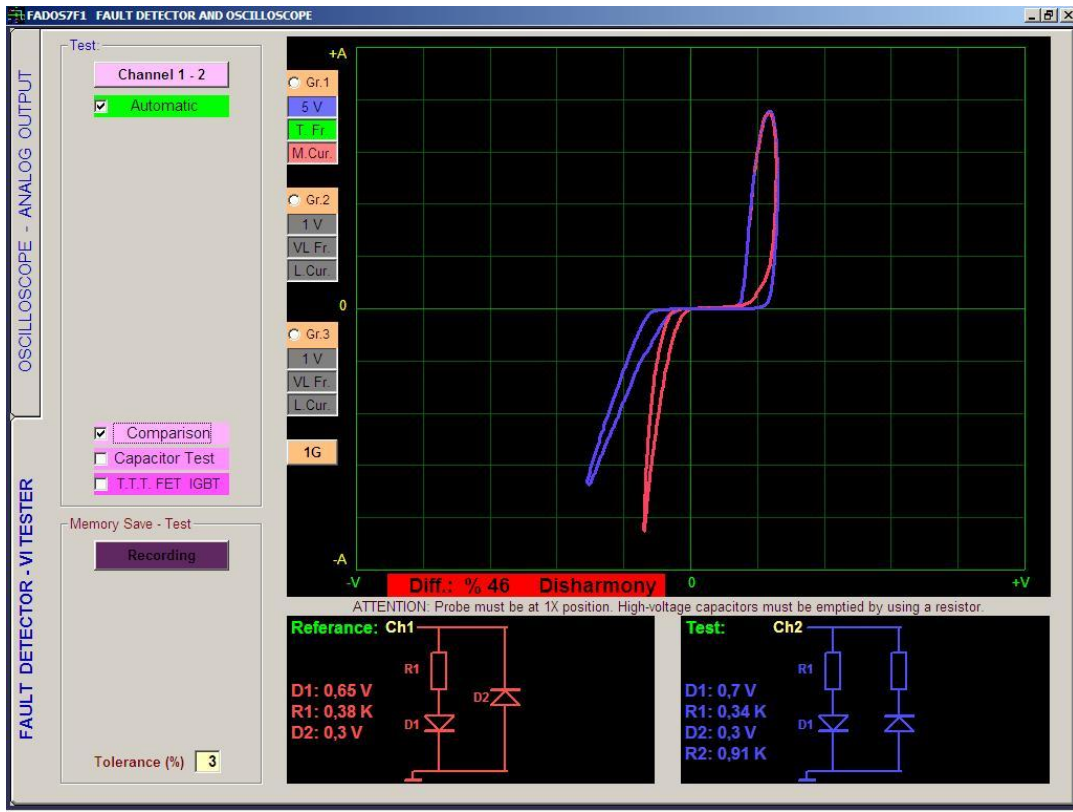
Resim 25: Karşılaştırmalı Test – Entegre Hatası
