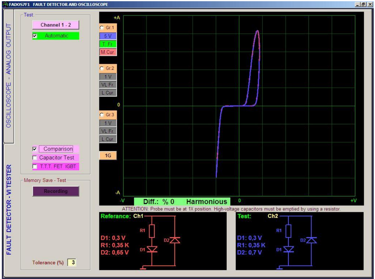
Resim 19: Sağlam Entegre Pini VI Grafiği– 2 Entegrenin Karşılaştırılması
